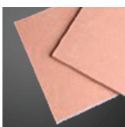
**Nefalit 16:** Sınıflandırma sıcaklığı 1200 °C olan, seramik elyaf esaslı, asbest içermeyen bir üründür. Yoğunluğu 1000 kg/m<sup>3</sup>'dür ve kiremit rengindedir. 1150 °C sıcaklıkta 24 saat süreyle bekletildiğinde küçülme değeri % 4'ün altında olan Nefalit 16, yüksek aşınma direncine sahip yapısı ile, yüksek sıcaklıklarda mükemmel izolasyon sağlamaktadır. Diğer tüm Nefalit malzemelerin kullanım alanlarının yanı sıra, en etkili kullanım yeri savurma dökümdür.
