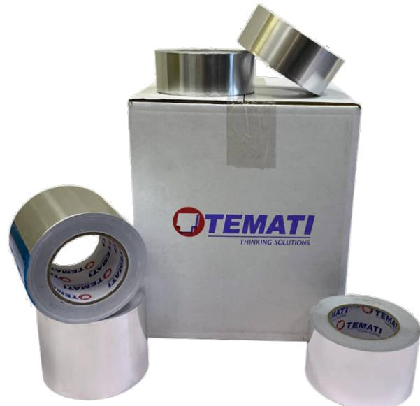
Uzun ömürlü, ultraviyole dirençli, soğuk havalara dayanıklı akrilik yapıştırıcıyla kaplanmış yumuşak alüminyum bant. 50, 75 ve 100 mm genişliklerde ve 100 metre rulo uzunluğunda mevcuttur. Bir tarafı, yapışkan yüzeyi korumak için resmi IMO direksiyon simidini ve ECB Onaylı Kuruluş numarasını gösteren beyaz bir Kraft kağıdıyla kaplanmıştır.
