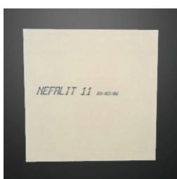
**Nefalit 11:** Sınıflandırma sıcaklığı 1100 °C olan, mineral elyaf esaslı, asbest içermeyen bir üründür. Yoğunluğu 1100 kg/m<sup>3</sup> olan Nefalit 11, sarı renktedir. 1000 °C sıcaklıkta 24 saat süreyle bekletildiğinde küçülme değeri % 1'in altında olan bu ürün, diğer Nefalit ve Millboard uygulamalarının yanı sıra özellikle aşağıdaki uygulamalarda kullanıldığında mükemmel sonuçlar elde edilir.
