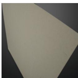
**Nefalit 7:** Sınıflandırma sıcaklığı 850 °C olan, mineral elyaf esaslı, asbest içermeyen bir üründür. Yoğunluğu 850 kg/m<sup>3</sup> olan Nefalit 7, gri/bej renktedir. 750 °C sıcaklıkta 24 saat süreyle bekletildiğinde küçülme değeri % 2'nin altındadır.
