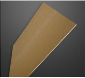
**Nefalit 5:** Sınıflandırma sıcaklığı 750° C olan, mineral elyaf esaslı, asbest içermeyen bir üründür. Yoğunluğu 950 kg/m<sup>3</sup> olan Nefalit 5, sarı/bej renktedir. 750° C sıcaklıkta 24 saat süreyle bekletildiğinde küçülme değeri % 2'nin altındadır.
